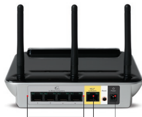
Ports pour Alimantation Port modem
