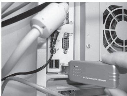
Figura 3. Instalación para PC de sobremesa
